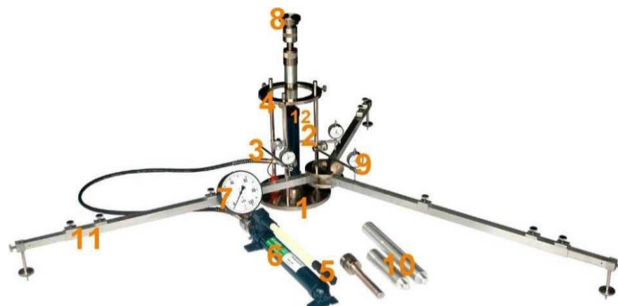
Rys. 1.1. Aparatura VSS z trzypunktowym pomiarem przemieszczenia płyty
