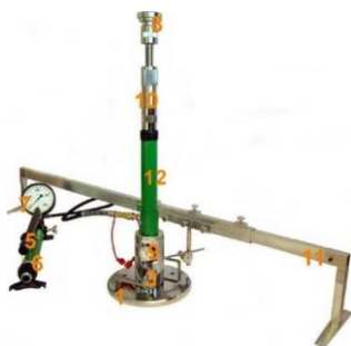
Rys. 1.2 Aparatura VSS z jednopunktowym pomiarem przemieszczenia płyty
